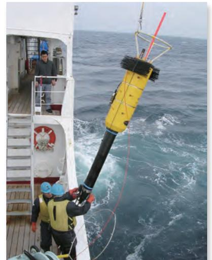
超深海乱流計を使った海洋観測。水深6000mまで自由落下しながら数cmスケール以下のマイクロな乱流の強度を測定します。
