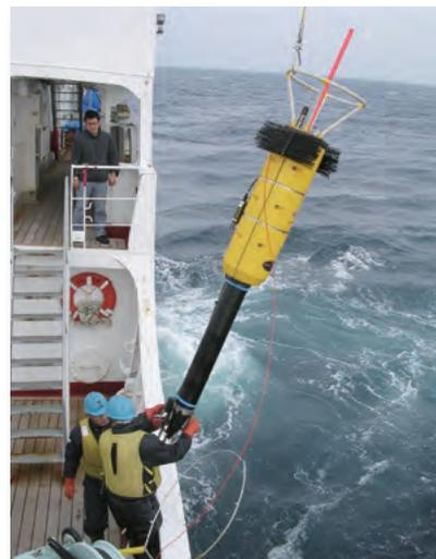
超深海乱流計を使った海洋観測。水深6000mまで自由落下しながら数cmスケール以下のマイクロな乱流の強度を測定します。
