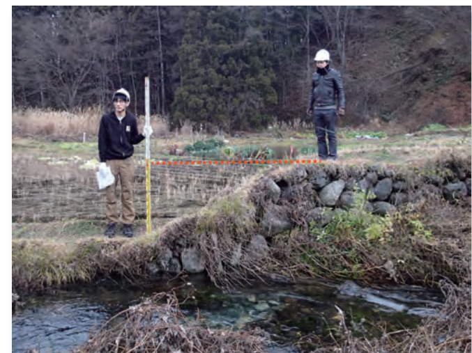
長野県北部の地震(2014年11月22日)で生じた地表断層。元々平坦な畑だったが、右側が逆断層運動により約85cm相対的に隆起した。
