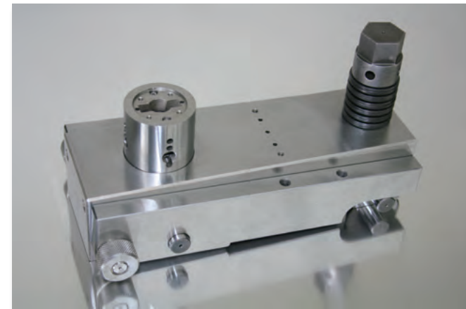
ダイヤモンドアンビル装置。片手で持てる程度のサイズながら、地球中心を超える400万気圧程度までの発生が可能であり、物理、化学、生物、地学の各分野において利用されている。
