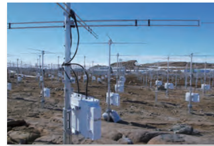
南極昭和基地に設置された大型大気レーダー (PANSYレーダー) (国立極地研究所提供)
