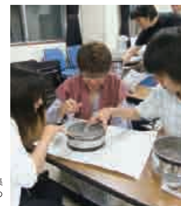
▶「野外調査III」では、富士山の火山灰層から試料を採集し、その粒度分布から噴火のダイナミズムを推測します。
