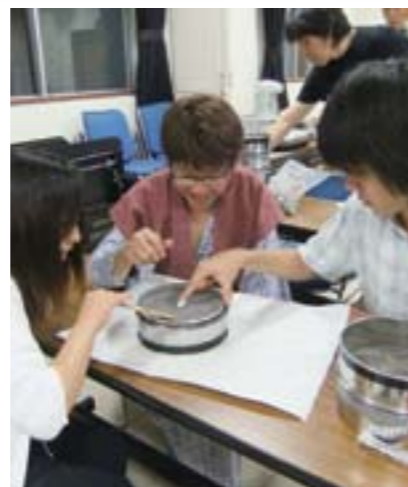
▲「野外調査Ⅲ」では、富士山の火山灰層から試料を採集し、その粒度分布から噴火のダイナミクスを推測します。
