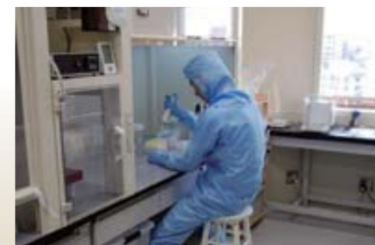
▲高精度化学・同位体分析に必要なクリーンルームでの化学分離作業
