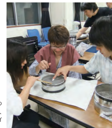
▶「野外調査III」では、富士山の火山灰層から試料を採集し、その粒度分布から噴火のダイナミクスを推測します。
