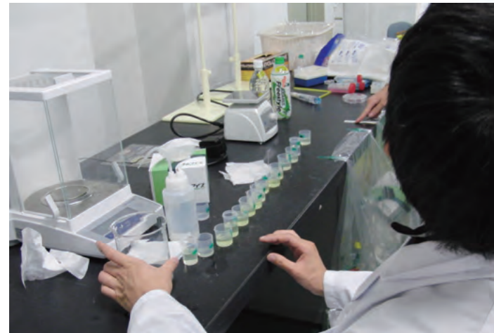
▲「地球環境化学実習」では、大学近くの井戸水を採集し、窒素濃度を測定する。
